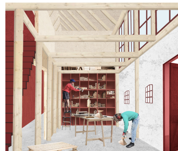
Lade omdannet til fælles kontorer og værksted. Tagkonstruktionen er hævet for at tilføje vinduer og øge lysindfald.
