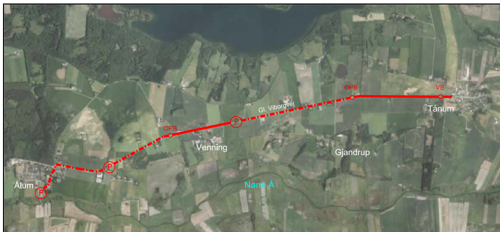
Figur 2.2.1 Plan: Afskærende ledning fra Ålum til Tånum.
