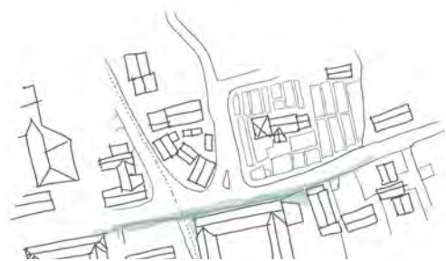
Rørlagt bæk og regnvand langs facader
